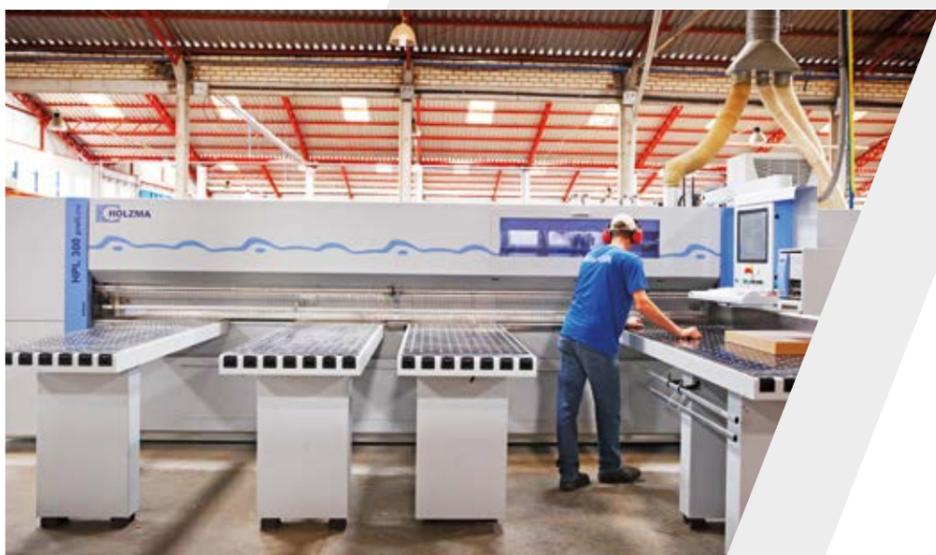
Seccionadora: todo plano de corte é serrado automaticamente.
